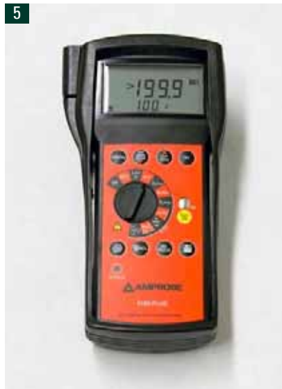
5 Telaris 0100 Plus von Amprobe, sehr leichtes und preisgünstiges Gerät, misst niedrige Netzimpedanzen falsch.
